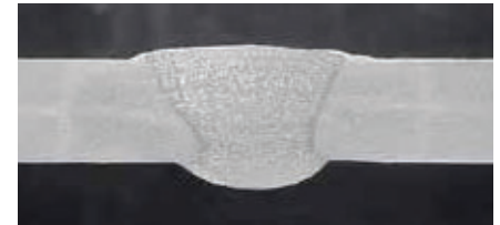
Soldadura de aluminio cabezal con cabezal 4 mm. Óptima penetración y estabilidad del baño. Solda de alumínio cabeça a cabeça de 4 mm. Excelente penetração e estabilidade no banho
