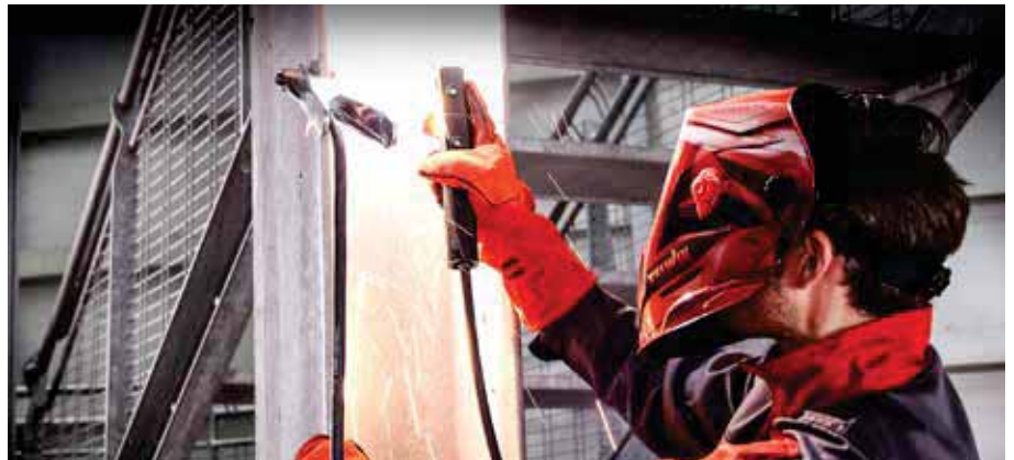
Un courant de soudage moyen plus faible rend le bain de soudure plus visqueux, moins liquide, ce qui convient au soudage positionnel. • Ein niedrigerer durchschnittlicher Schweißstrom macht das Schweißbad zähflüssiger, weniger flüssig und eignet sich für das Positionsschweißen.
